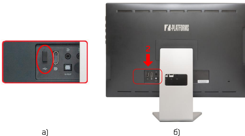
Рис. 6 – Вставка радиомодуля в порт USB2.0 на задней панели ввода/вывода
