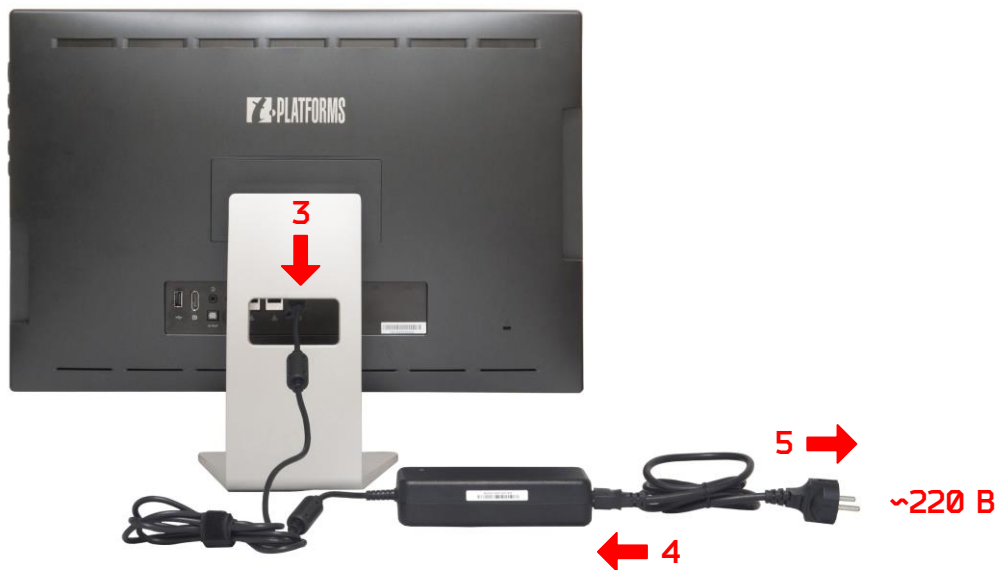
Рис. 7 – Подключение адаптера и кабеля электропитания
