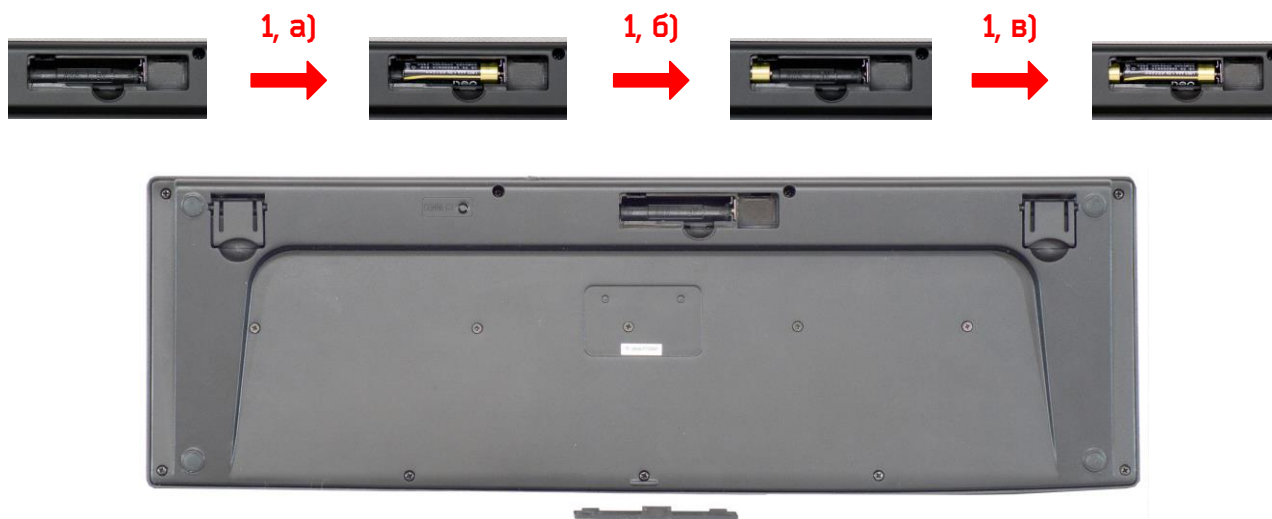
Рис. 5 – Установка батареек в клавиатуру и мышь
